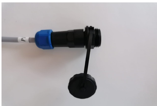
Рис.3 Снятая защитная «заглушка»
